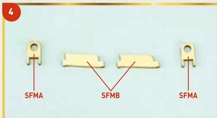
**4** Извлеките из матрицы детали SFMA и SFMB и с помощью надфиля обработайте их края.
